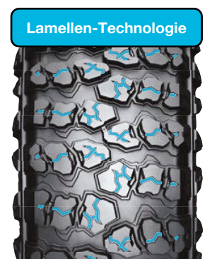
Lamellen-Technologie vom GEOLANDAR AT/S.
