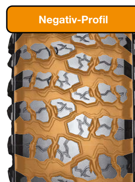
Negativ-Profil und Lamellen für optimale Selbstreinigung und Traktion.
